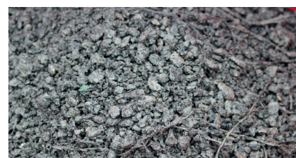
Schadeloos vezelresidu in het freesmateriaal
