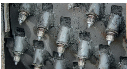
Freesmachinekop na het frezen van S&P asfaltwapening
